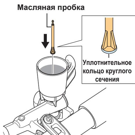
**17. Снимите масляную воронку, пока она все еще заткнута масляной пробкой.**
