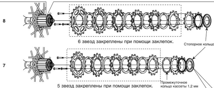
При установке звезд HG применяйте специальный инструмент (TL-LR15) для затяжки стопорного кольца.
