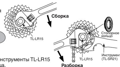
При установке звезд HG применяйте инструменты TL-LR15 и TL-SR21 для снятия стопорного кольца.
