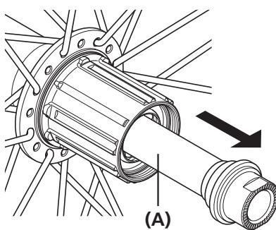
Вытащите ось втулки из барабана трещотки.
