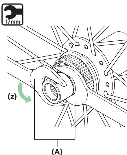
Используйте гаечный ключ для ослабления стопорной гайки двойного замка.
