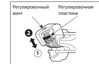
Натяжение пружин можно регулировать поворотом регулировочных винтов, изменяя усилие застегивания. Один щелчок регулировочного винта изменяет натяжение на один шаг. В одном обороте - четыре шага.
