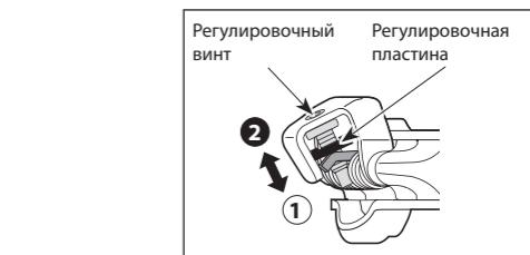
Натяжение пружин можно регулировать поворотом регулировочных винтов, изменения усилие застегивания.
