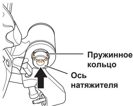
2. Придерживая стопорную пластину, снимите ось натяжителя путем ее поворота с помощью шестигранного ключа.
