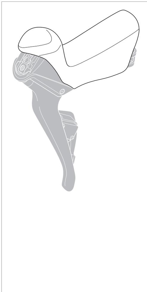
Вдавите защелки кожуха держателя в пазы на узле держателя.
